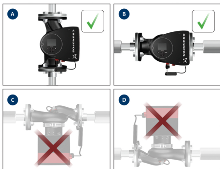
Mootori horisontaalse võlliga paigaldatud pump
