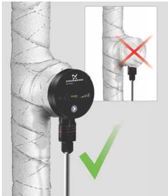
Joonis 4 Pumbakorpuse isoleerimine
