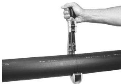
Joonis 51. Soovitatav on kasutada ketastorulõikurit
