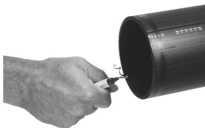
Joonis 52. Sae kasutamisel tuleb toruotstelt eemaldada kraadid
