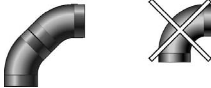
Joonis 8. Kasutada ainult 45° põlvi, mitte 90° põlvi
