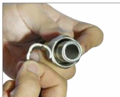
Paigalda kinnitusklamber/poolring kokku surutud voltide vahele
